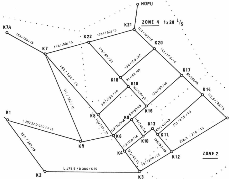
AQUANET ist ein Programm zur Berechnung von Druckwasserleitungen. Auf der Grundlage des Fliessgesetzes von Darcy und den Beziehungen von Hagen-Poiseuille für laminares bzw. Colebrook für turbulentes Fliessen werden die nicht-linearen Gleichungen des Netzes aufgestellt und iterativ aufgelöst. Es können praktisch beliebig grosse Leitungsnetze mit beliebigen Pumpen, Hydranten, Reservoirn und Schiebern berechnet werden.
