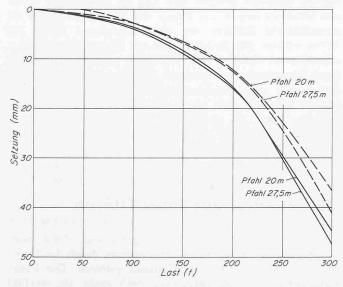
Bild 13. Probebelastung von je zwei LS-Pfählen von 20 und 27,5 m Länge
