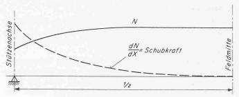
Bild 11. Verlauf der Umlagerungskraft N
