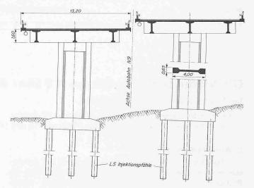
Bild 2. Querschnitt beider Viadukte, Massstab 1:350
