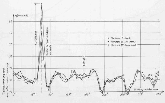
Bilder 14a bis 14c. Vorverformungen und Verformungen eines planmässig vorgebeulten Zylinders
