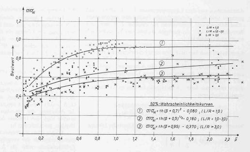
Bild 6.  $90^0$ /o-Wahrscheinlichkeitskurven für die Zylinderschale unter Längsbelastung mit Innendruck; Beulwert in Abhängigkeit vom Druckparameter p=q  $R^2/Et^2$
