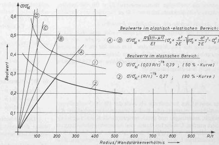
kritischen Beulspannungen, durch die klassische Beulspannung dividiert, in Abhängigkeit vom Längen/Radiusverhältnis L/R aufgetragen und in Ergänzung der Ansätze von W. Ballerstedt/ H. Wagner [2] und S. Kanemitsu/N. Nojima [7] durch Funktionen für R/t = 500,500-900,900-1400,1400-2400,2400-4000 approximiert worden (Bild 3). In der so ermittelten Formel – sie kann auch zur Bemessung kurzer Zylinderschalen herangezogen werden –
