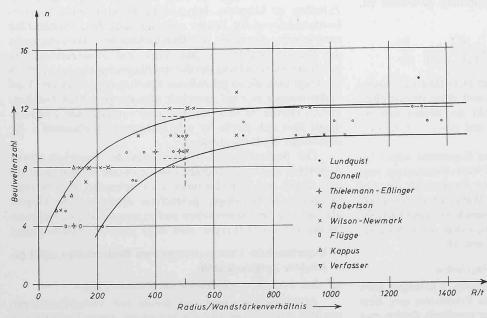
nicht genauer untersucht worden. Aus diesem Grund wurden zunächst – um eine erste Aussage machen zu können – an mehreren geschweissten Tankbauwerken ( $R/t=8550/8\,$  mm) Verformungsmessungen durchgeführt. An den leeren Tanks sind dabei im Bereich der horizontalen automatengeschweissten
