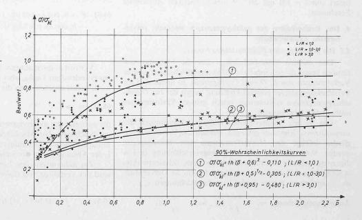
Bild 7. Wahrscheinlichkeitskurven für die Zylinderschale unter allseitigem Aussendruck
