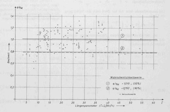
Abhängigkeit von dem Längenparameter  $\overline{l} = L/(R t)^{1/2}$  aufgetragen und durch entsprechende Funktionen approximiert. (Eine differenzierte Auswertung für einzelne L/R- bzw. R/t-Bereiche war wegen der geringen Anzahl von Versuchsergebnissen nicht möglich.)
