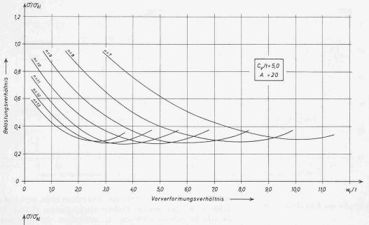
Bilder 9a und 9b. Abhängigkeit der Beullast von der Vorverformung
