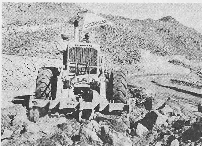
Bild 5. Der heckmontierte leichte Aufreisser wird zum Aufreissen von zähem Material eingesetzt
