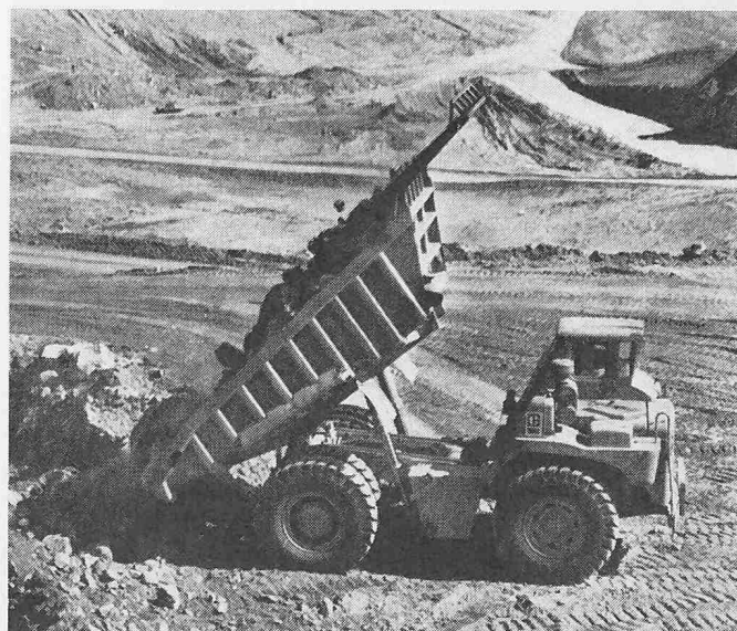
Bild 1. Muldenkipper Caterpillar 773. Die zwei dreistufigen Hydraulikstempel kippen den beladenen Aufbau in 12,7\text{ s}
