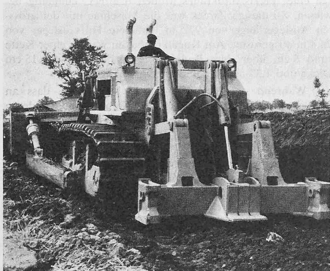
Bild 1. Allis-Chalmers Bulldozer HD-41. Zugkraft 81 t, Brennstofftank 1135 l. Der 9,3 t schwere Aufreisser hat eine Eindringtiefe von 1,067 m. Felsstellen, die früher gesprengt werden mussten, können mit diesem Gerät aufgerissen werden
