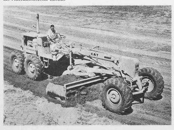
Bild 2. Der Scharstabilisator wirkt als dritter Aufhängepunkt und fängt die durch schnelles Fahren über Unebenheiten entstehenden Stösse ab
