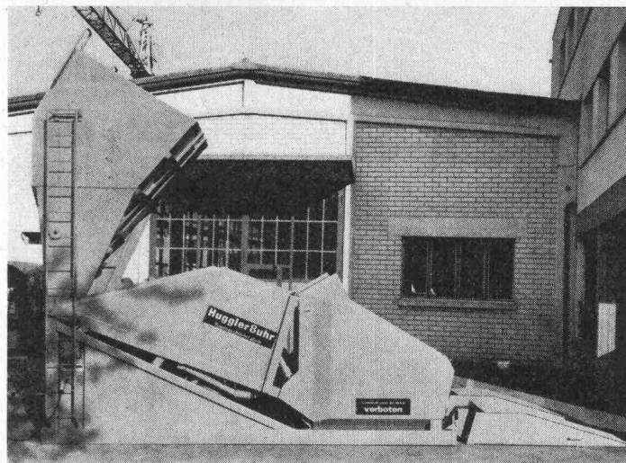
Bild 2. Huggler-Doppelumschlaggerät mit zwei Mulden
