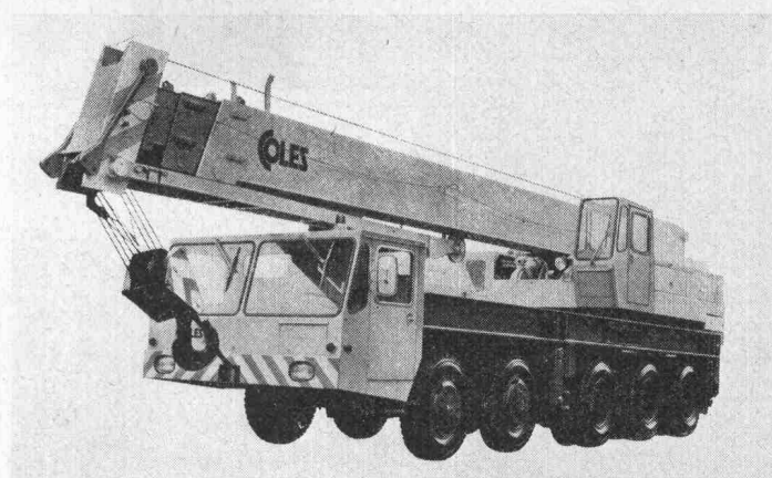
Bild 2. Der Coles-Autokran LH 450 erreicht mit dem vierteiligen Teleskopausleger und mit Spitzausleger eine maximale Hakenhöhe von 53 m.
