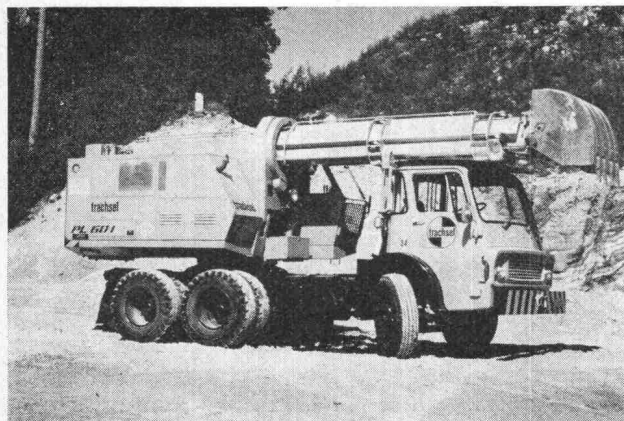
Bild 2. Teleskopbagger Combi-Craft Typ PL 60 MF
