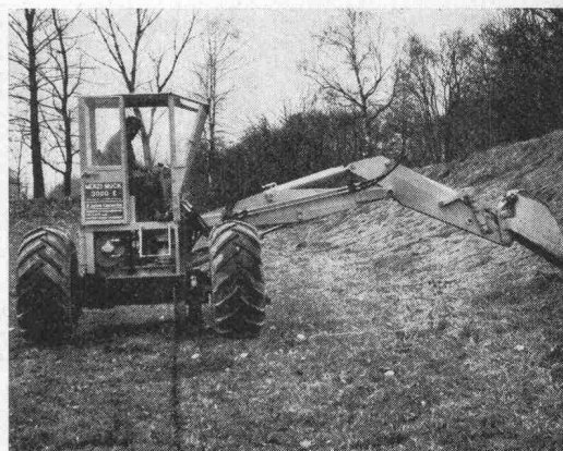
Dank dem Führungs- und Halterad wird die Stabilisierung bei schwierigen Arbeiten erheblich erhöht
