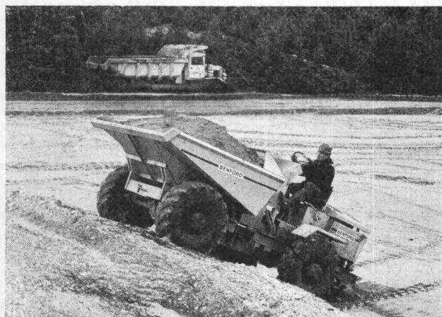
Bild 2. Benford-Dumper Modell TT 3 1/2 F mit Vierradantrieb, zentraler Knicklenkung und 3,5 t Tragfähigkeit
