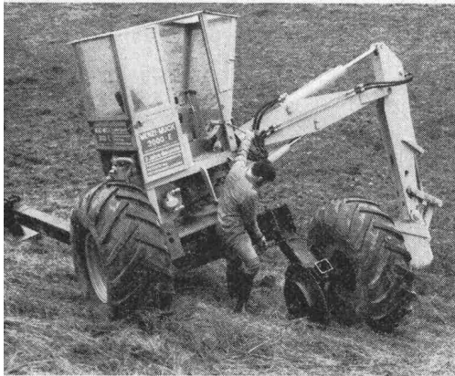
Das Anpassen der Maschine an das Gelände dank der neuen Hangverstellung rasch und leicht möglich
