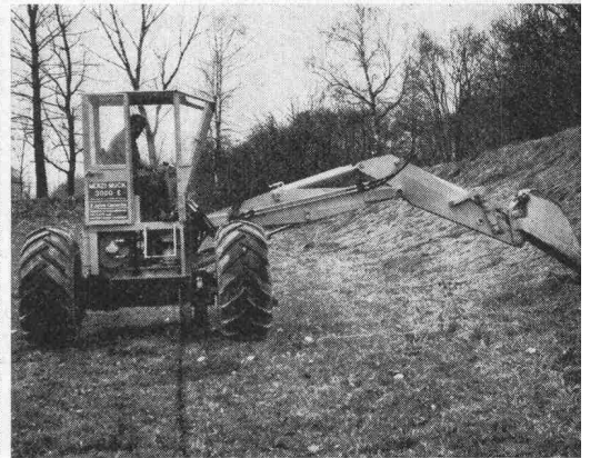
Dank dem Führungs- und Halterad wird die Stabilisierung bei schwierigen Arbeiten erheblich erhöht
