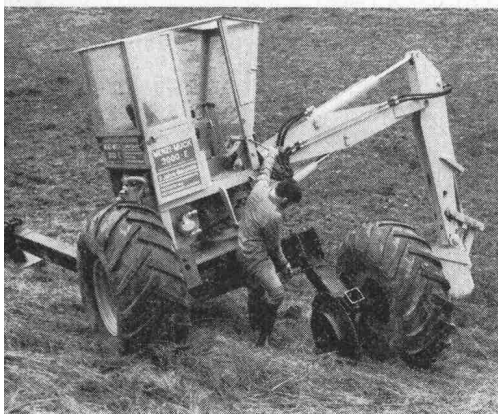
s Anpassen der Maschine an das Gelände dank der neuen Hangverstellung rasch und cht möglich
