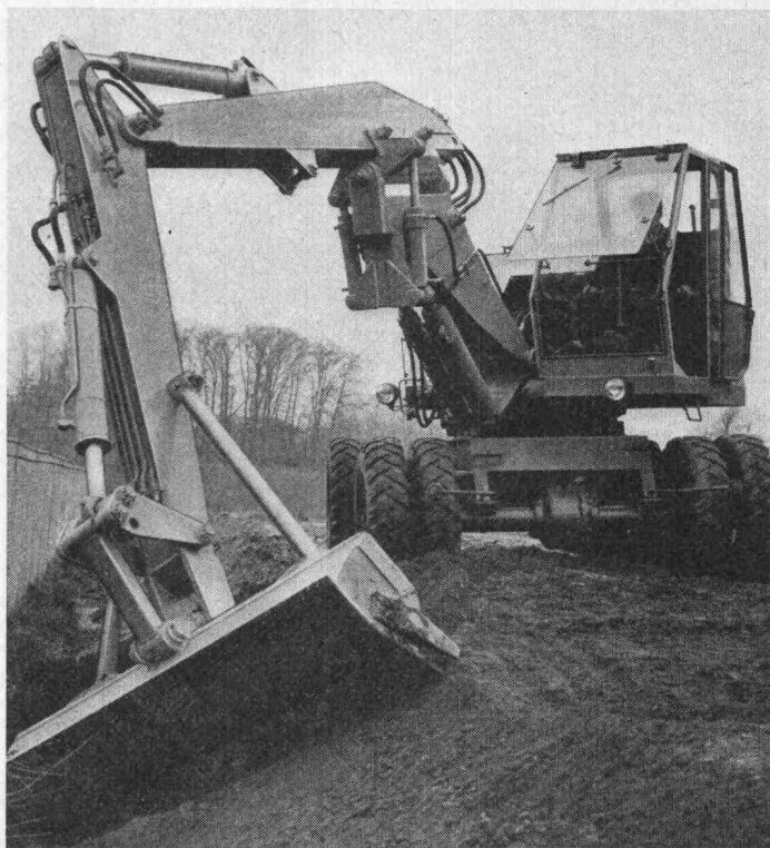
Bild 1. Atlas-Hydraulik-Bagger Typ AB 1302. Man erkennt die Kippvorrichtung des Auslegers, welche Böschungsarbeiten mit Neigungen bis 45° erlaubt
