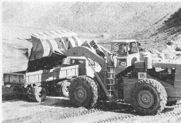
Bild 1. Luftbereifte Ladeschaufel International-Hough Typ H-400 B
