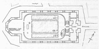
Bild 5. Kirche Wil. Grundriss 1:600. Erhaltungsvorschlag von Manuel Pauli 1969: Ein neuer Kultraum mit erhöhtem Saalkomfort wird in das Kirchenschiff hineingebaut. Äussere und innere Substanz bleiben erhalten. Der Einbau könnte später wieder entfernt und anderweitig verwendet werden. Im Dachstock werden Jugendräume oder ähnliches geschaffen
