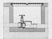
Rückstaudoppelverschluss TRIPLEX für durchgehende Leitungen
