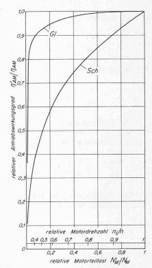
Bild 15 (rechts). Wirkungsgrade für drehzahlregelbare elektrische Ventilatorantriebe. *Gl* Gleichstrommotor mit Thyristorspeisegerät, *Sch* Schleifringankermotor mit Wasserwiderstand
