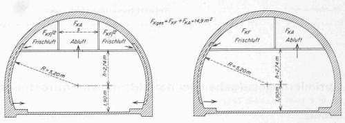
Bilder 2 und 3. Häufig verwendetes Tunnelprofil mit zwei Fahrspuren und über der Zwischendecke angeordneten Frisch- und Abluftkanälen. Beidseitige Anordnung der Frischluftkanäle bewirkt eine etwas gleichmässigere Zuführung der Frischluft in den Verkehrsraum
