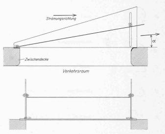
Bild 8. Einstellbare Abluftklappe für den Einbau in die Tunnelzwischendecke (Konstruktion Luwa AG)
