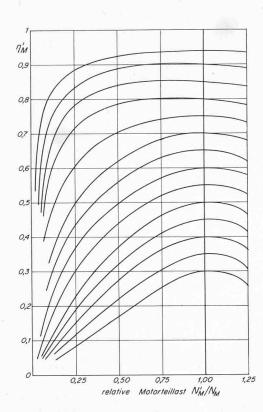
Bild 14 (links). Abhängigkeit der Wirkungsgrade  $\eta_M$  für Asynchron-Käfigmotoren von der Belastung
