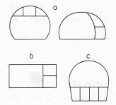
Bild 1. Lüftungskanäle werden zweckmässig parallel zum Verkehrsraum geführt. a Frisch- und Abluftkanal oberhalb oder seitlich der zweispurigen Fahrbahn. b Tunnel mit Lüftungskanälen nahe der Oberfläche, ohne Bergdruck; für Unterführungen von Flüssen oder Plätzen. Ausführung aus vorgefertigten Elementen im Tagbau. c Luftkanäle unterhalb der Fahrbahn bedingt stark ausgebildete Fahrbahnplatte
