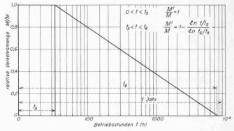
Bild 11. Häufiger Fall einer Dauerkurve des Verkehrs
