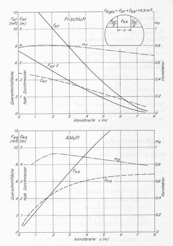
Bilder 10a (oben) und 10b (unten). Querschnittsflächen, hydraulische Durchmesser und Formfaktoren für (a) Frisch- und (b) Abluftkanäle, die in der Tunnelkalotte untergebracht sind, in Abhängigkeit von der Abluftkanalbreite s
