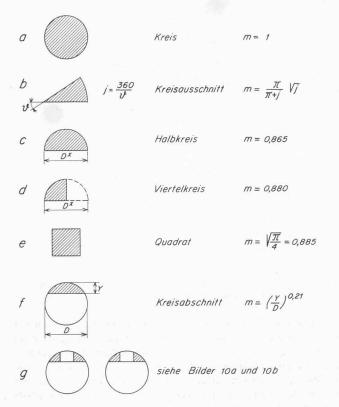
Bild 9. Formfaktoren m verschiedener Kanalquerschnitte zur Berechnung der hydraulischen Durchmesser
