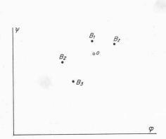
Bild 21. Lage der Betriebspunkte in dimensionsloser Darstellung, wenn ein und derselbe Ventilatortyp für verschiedene Lüftungssysteme im Tunnel verwendet wird
