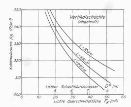
Bild 5 (links). Kubikmeterpreise für vertikale Lüftungsschächte
