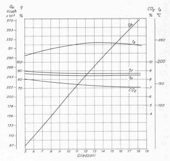
Bild 2. Leistungsdiagramm des Kessels GAF 300
