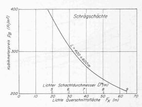
Bild 6 (rechts). Ungefähre Kubikmeterpreise für schräge Lüftungsschächte
