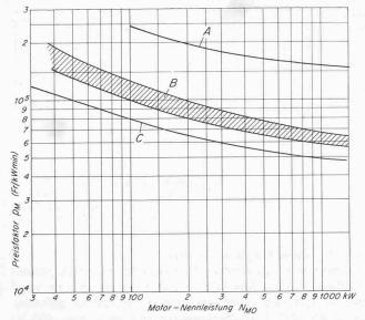
Bild 7. Preisfaktor  $p_M$  für elektrische Antriebsmotoren: A Gleichstrom-Kompoundmotoren (Normalausführung). B polumschaltbare Asynchron-Käfigmotoren für Niederspannung (bis 600 V) in Spezialausführung, horizontalachsig, Bauform B 14, Wälzlager, innenventiliert. C Asynchron-Käfigmotoren, nur eine Drehzahl, Normalausführund B 3 oder B 5, Schutzart P 33, Wälzlager
