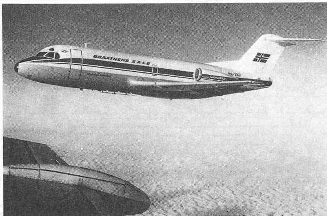
Bild 2. Das niederländische Verkehrsflugzeug Fokker Friendship mit zwei Spey-Junior-Triebwerken in Heckanordnung während der Flug-erprobung (Aufnahme 5511 der VFM)
