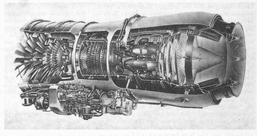
den ersten Ausführungen dieses Triebwerkes für die Schaufelräder der Niederdruckturbinen verwendet wurde, musste durch eine Nickellegierung ersetzt werden. Die USN schrieb auch den Einbau einer Brennstoffvorwärmeeinrichtung sowie einen Korrosionsschutz für die Hochdruck-Leitschaufeln vor. In dieser Ausführung beträgt die Startschubleistung in Meereshöhe 6805 kp (ISA, bis 5 ° C), 4535 kp in 3000 m und 2835 kp in 9000 m Höhe und Mach 1,2.
