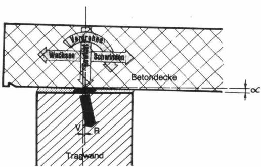
Die Betondecke kann sich auf der Tragwand verschieben und verdrehen, die Last bleibt zentrisch
