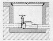
Rückstaudoppelverschluss TRIPLEX für durchgehende Leitungen
