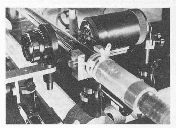
elektrisches Signal, dessen Frequenz gleich der Differenzfrequenz beider Lichtanteile ist. Diese Differenzfrequenz ist wegen des Doppler-Effekts ein direktes Mass für die Geschwindigkeit der Teilchen und damit der umgebenden Strömung.
