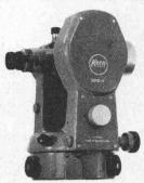
Kern DKM 2-A Sekundentheodolit mit automatischer Höhenkollimation
