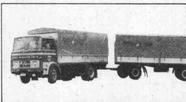
3) Mercedes: 1417-Überlandlastwagen Motor: Mercedes OM 327 (170 PS) Getriebe: Allison MT-41 (Automat)
