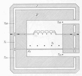
Bild 7. Leuchtenkalorimeter zur Messung der Kenndaten belüfteter Leuchten
