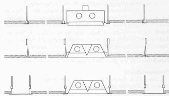
Bild 2. Verschiedene Montagesysteme. Oben Einlegemontage, Mitte unsichtbare Unterkonstruktion, unten System mit Bandraster
