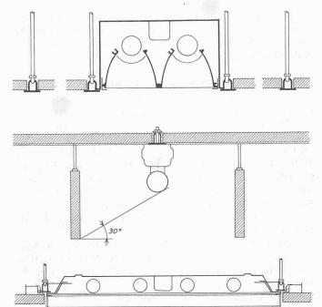
Bild 5. Beleuchtungslösungen für Grossraumbüros. Oben Spiegelraster-Einbauleuchten, Mitte freistrahlende Schienenleuchten zwischen Akustik-Schürzen, unten Einbauleuchten mit prismatischen Abdeckwannen
