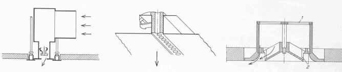
Bild 9. Verschiedene Ausführungsformen von Zuluftelementen. Links Deckenluftverteiler, Mitte Düsenleisten, rechts runde Deckenluftverteiler. 1 Regelung des Luftstroms durch Querschnittsveränderung; 2 Je acht gegeneinander verdrehbare Ausblasöffnungen
