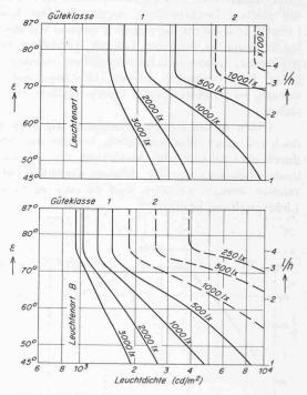
Bild 4. Höchstzulässige Werte der Leuchtendichte von Leuchten in den einzelnen Winkelbereichen. Leuchtenart A (oben) gilt für Aufbauleuchten, die parallel zur Blickrichtung montiert sind, und für Einbauleuchten. Leuchtenart B (unten) gilt für Aufbauleuchten mit leuchtenden Seitenteilen, die quer zur Blickrichtung montiert sind
