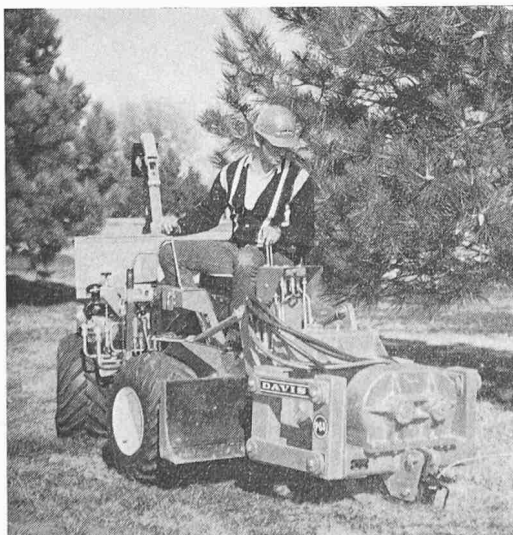
Bild 1. Kabelverlegegerät Typ Davis P 60 an Traktor angebaut
