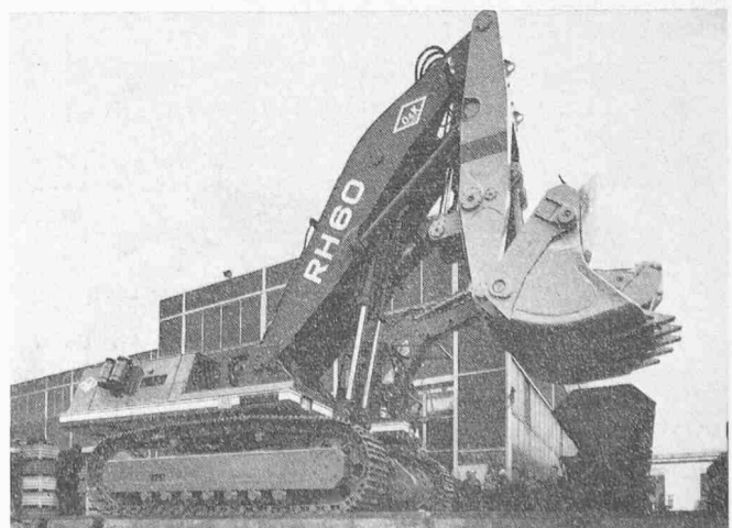
Bild 4. Der 110 t schwere Hydraulik-Bagger Typ RH 60 der Orenstein & Koppel beim Verlassen der Werkshalle
