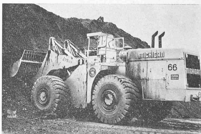
Bild 2. Schaufellader Michigan 475 für Schwereinsatz
