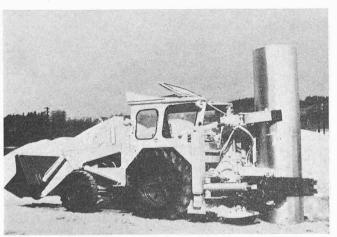
selten kurz hintereinander an verschiedenen Orten eingesetzt werden. Diese Umstände führten die JCB, Hamburg, dazu, eine selbstfahrende Arbeitseinheit für das Verrohren von Bohrlöchern bis 800 mm Durchmesser zu entwickeln (Bild 3). Diese besteht aus dem Baggerlader Typ 3C der selben Firma und der eigentlichen Verrohrungsmaschine. Dieses Aggregat wird an Stelle der Heckbagger-Vorrichtung montiert und kann in allen Funktionen vom Fahrerstand des Baggers aus gesteuert werden.
