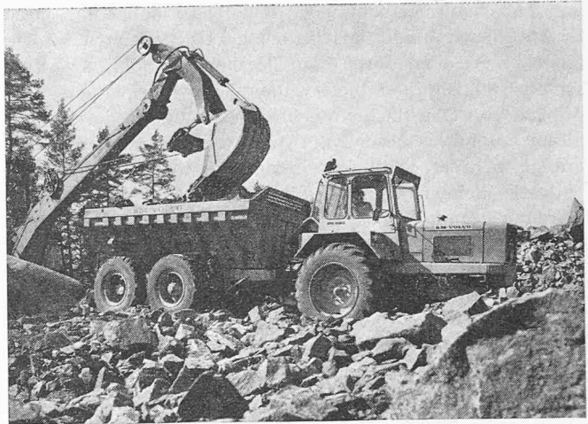
Bild 4. Muldenkipper Typ DR 860 im Einsatz. Leergewicht 12,3 t, Muldeninhalt 10,5 m³, Motorleistung 110 PS bei 2400 U/min
