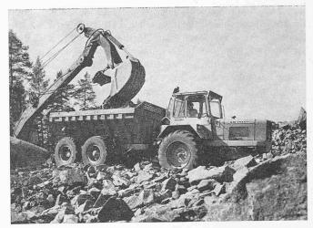
Bild 4. Muldenkipper Typ DR 860 im Einsatz. Leergewicht 12,3 t, Muldeninhalt 10,5 m³, Motorleistung 110 PS bei 2400 U/min
