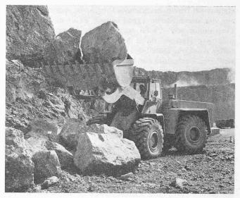
Bild 6. Der 16-t-Radlader Hanomag B 16 bei der Vorführung im Steinbruch
