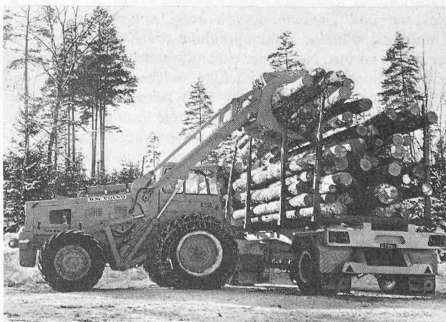
Bild 2. Lader Typ LM 840 ausgerüstet mit einem Sonder-Kippgreifer für Rundholz, Rohre usw.
