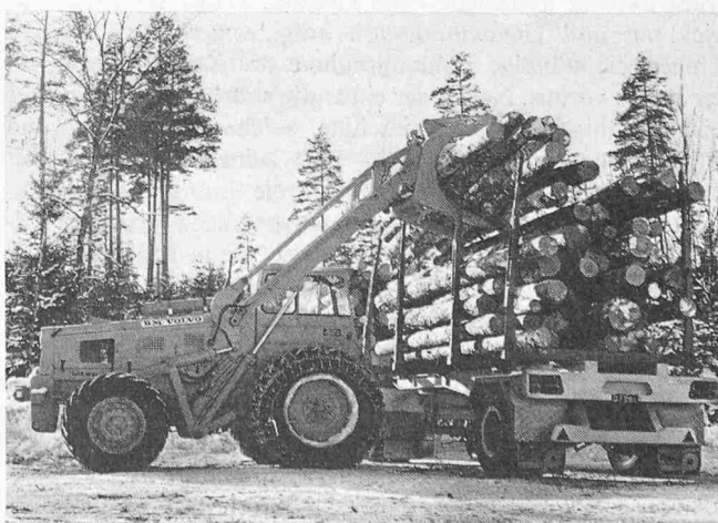
Bild 2. Lader Typ LM 840 ausgerüstet mit einem Sonder-Kippgreifer für Rundholz, Rohre usw.
