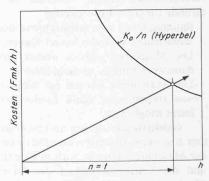
Bild 3. Reparaturkostenkurve geht durch den Nullpunkt. Wirtschaftliche Lebensdauer = t. Nach dieser Betriebszeit sind die Reparaturkosten gleich dem Kaufpreis
