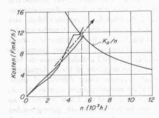
Bild 1. Diagramm der durchschnittlichen Kosten pro Motorlaufstunde für zwei Radladeschaufeln. Abszissen-Achse: Betriebsdauer in 1000 Motorlaufstunden. Ordinaten-Achse: Kaufwertanteil pro Stunde und durchschnittliche Reparaturkosten in Fmk/h. Wirtschaftliche Lebensdauer 5300 Motorlaufstunden
