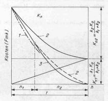
Bild 8. Diagramm des Gebrauchswertes, zugehörig zu Bild 7. Zu Vergleichszwecken wurde die Gebrauchswertkurve des Modellfalles 2 auf die Grundlage von Fall 38 verschoben. Die Kurven weichen gegen das Ende der Lebensdauer voneinander ab
