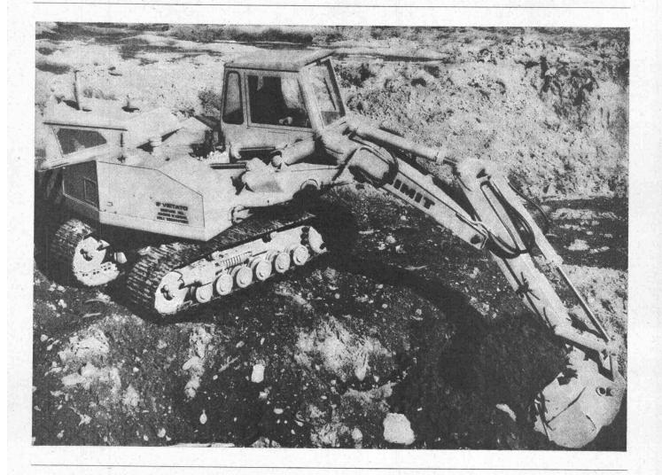
Der SIMIT Hydraulikbagger hat einen dreiteiligen Ausleger Das heisst:
