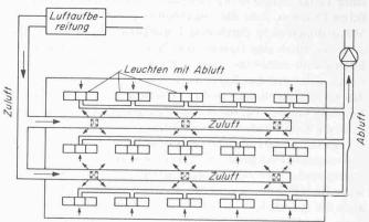
Bild 11. Klimaanlage und Beleuchtung im Grossraum. Grundrissprinzip
