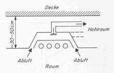
Bild 6. Luftabsaugung durch die Abluft-
