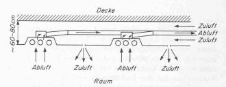
Bild 10. Klimaanlage und Beleuchtung in der Kernzone eines Gebäudes
