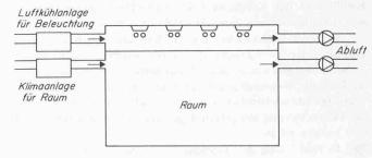
Bild 7. Getrennte Lüftungsanlage für die Leuchtenkammer
