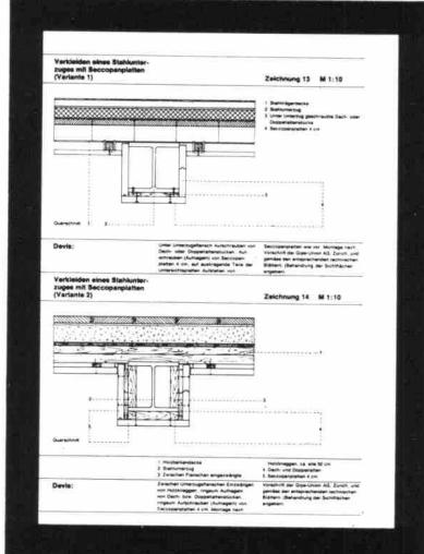
Sicherheitswert, wie die Prüfungsresultate auf Feuerwiderstandsfähigkeit bestätigen: SECCOPAN 2½ cm  $W_F = 49$  Minuten; SECCOPAN 4 cm  $W_F = 108$  Minuten. Sie sind damit «feuerhemmende» bzw. «feuerbeständige» Bauteile. Da sie überdies sehr preisgünstig sind, sollte man mit unsicheren Verkleidungen Schluss machen. In Sicherheit wiegen kann man sich nur dann, wenn man sicher baut!
