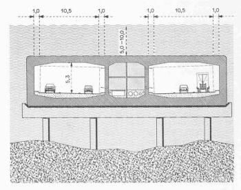
Bild 3. Normalprofil des Seetunnels, Massstab 1:500
