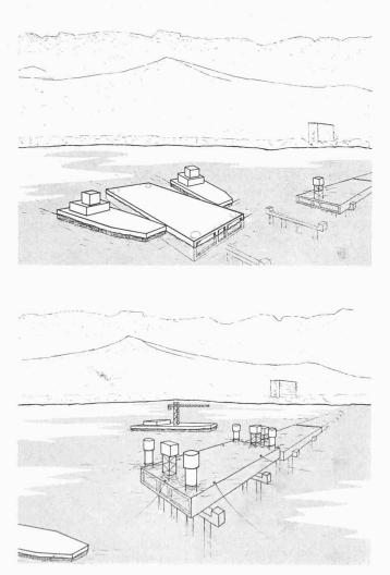
Bild 4. Montage der Seetunnel-Elemente; Antransport und Absenken
