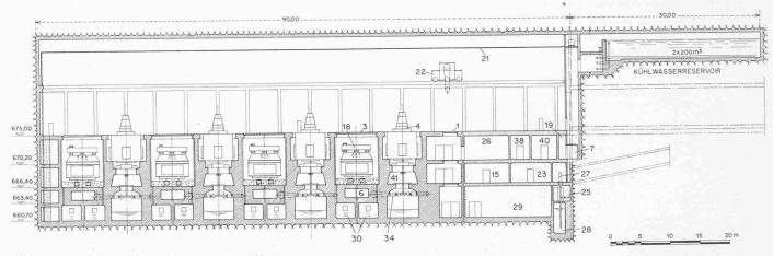
Bild 2. Zentrale San Miguel, Längsschnitt 1:700
