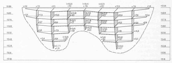
BELASTUNG: (ZAHL): WASSERLAST KOTE 1598 + ... WASSERLAST AUF KLUFTFLÄCHE "FALLA DE BOCONO"
