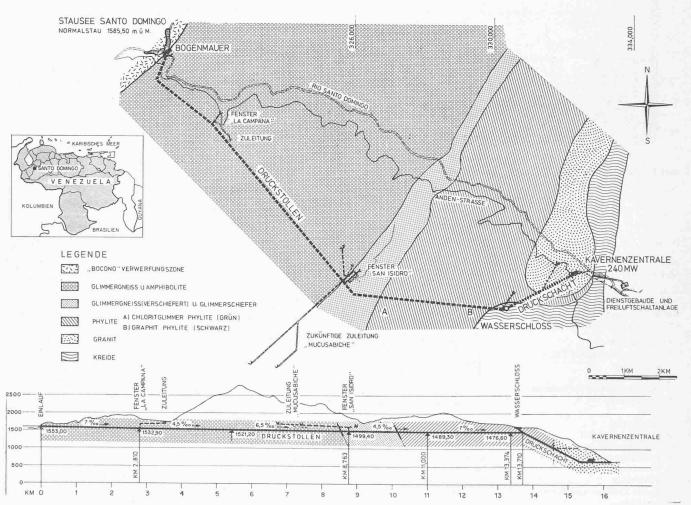
Bild 1. Übersichtsplan und Längenprofil der Gesamtanlage sowie allgemeine Geologie
