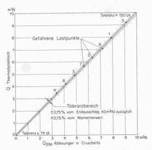
Bild 8. Vergleich der Anzeige der elektromagnetischen Durchflussmesseinrichtung mit den thermodynamisch ermittelten Durchflussmengen
