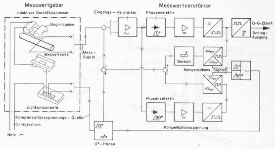
Bild 5. Blockschaltbild der Messeinrichtung
