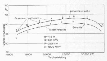
Bild 9. Gemessener Wirkungsgrad, verglichen mit den Modellversuchen und den Garantiewerten
