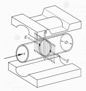
Bild 3. Schema und Wirkungsweise des induktiven Durchflussmessers
