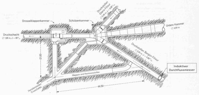
Bild 6. Wasserschloss Cruschetta, Grundriss 1:600
