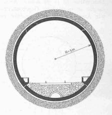
Bild 1. Querschnitt des untersuchten Tunnelprofils, Massstab 1:150
