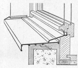
Lager-Profile: Legierungsgüte «Vitral und Aludur», Materialstärke 2 bis 3,5 mm, farblos, industrie-eloxiert, mattiert und nachverdichtet, mit Abdeckfolie lieferbar, inkl. Spezialbehandlung gegen Zement-Korrosionsschäden.
