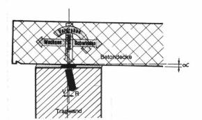
Die Betondecke kann sich auf der Tragwand verschieben und verdrehen, die Last bleibt zentrisch
