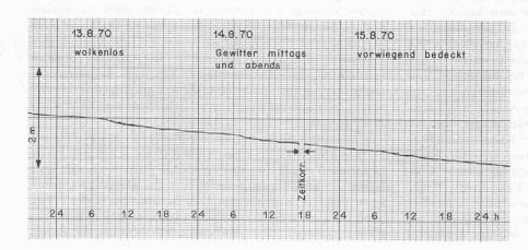
Bild 6. Ausschnitt aus einem Kryokinegramm vom 13. bis 15. August 1970. Registriergeschwindigkeit 7 cm/T, Registriermassstab 1:83
