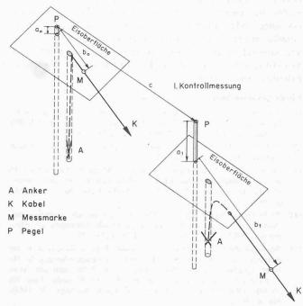
Bild 5. Schema der Anordnung beim Eisanker: Zwischen der Ausgangslage und der Kontrollmessung wandert der Gletscher um c; die Oberfläche senkt sich infolge der Ablation gegenüber dem Pegel; der Anker verschiebt sich und verkeilt sich im Eis; das Kabel schneidet sich ein. Bei Kontrollgängen wird der Pegelabstich  $a_n$  und die Distanz  $b_n$  vom Pegel zu einer fixen Marke M am Kabel gemessen
