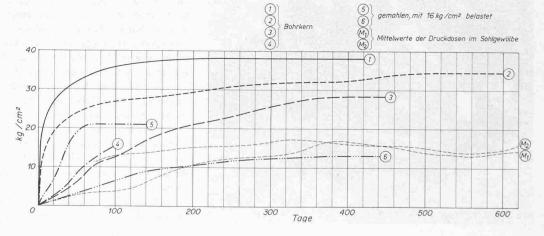
Bild 5. Zeitlicher Verlauf des Quelldruckes an verschiedenen Anhydritproben
