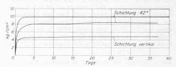
Bild 4. Zeitlicher Verlauf des Quelldruckes an drei Opalinustonproben
