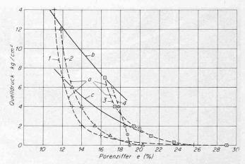
Bild 3. Quelldruck von vier verschiedenen Proben 1, 2, 3 und 4 von Opalinuston in Abhängigkeit von der ursprünglichen Porenziffer e. Kenndaten der Proben: Fliessgrenze  $W_L=41\%$ , Ausrollgrenze  $W_p=18\%$ ; Aktivität A=1. Porenziffer  $e_0$ , gemessen vor dem Einbau in den Oedometer bei Probe 1 12%, bei Probe 2 13%, bei Probe 3 20% und bei Probe 4 18,5%
