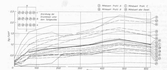
Bild 8. Zeitlicher Verlauf des Quelldruckes an der Messstelle 3 (Opalinuston)
