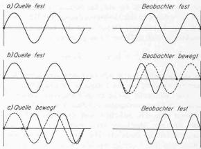
Bild 1. Schematische Darstellung des Doppler-Effekts
