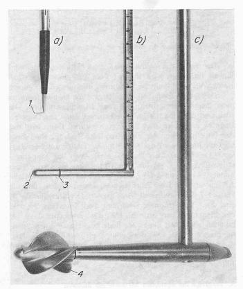
Bild 6. Heissfilmsonde (a), Staudruckrohr (b), Messflügel (c)
