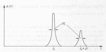
Bild 3. Frequenzspektrum des Streulichtes und des direkten Laserlichtes
