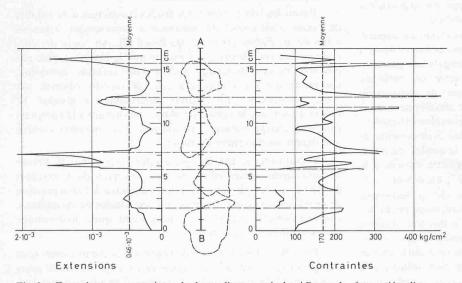
Fig. 3. Extensions et contraintes le long d'une verticale AB sur la face sciée d'un prisme soumis à une contrainte moyenne de 170 kg/cm³ (P. Dantu)
