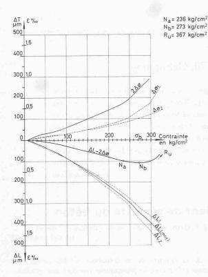
Fig. 1 (à gauche). Diagramme d'essai de l'éprouvette témoin T 2 (dosage 350 kg CP/m³) selon directives de A. Brandtzaeg
