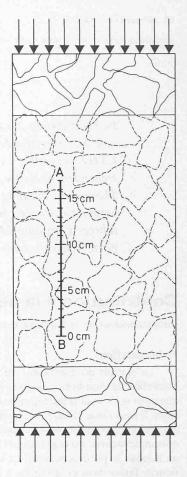
tance à l'écrasement sur cubes. De son côté, H. Rüsch estime que cette même limite est atteinte, pour un béton de 160 jours, entre 60 et 70% de la résistance ultime sur cubes; elle s'abaisse jusqu'à 50% pour des éprouvettes cubiques de 28 jours.
