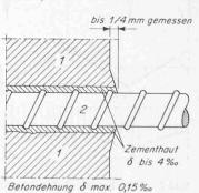
Bild 1. Verschiebung zwischen Stahl und Beton
