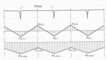
Bild 2. Vom Beton auf den Stahl übertragene Spannungen  $\sigma'_e$
