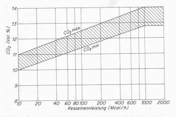
Bild 2. Richtlinien für CO<sub>2</sub>-Werte der Rauchgase in Funktion der Kesselnennleistung für die Messung der Betriebsüberdrücke im Feuerraum (KRW-VSO) 1002)
