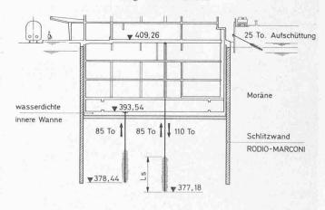
Bild 3. PTT-Betriebsgebäude in Zürich-Enge, Schnitt 1:750. 72 «Tubfix»-Anker 25 und 85 t
