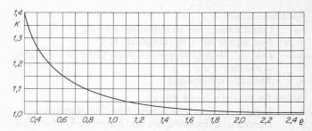
Bild 4. Bei hohen Gefällen ist für Vollast der Wert der Wasseranlaufzeit  $T_w$  in den Einstellformeln (1) und (2) (Tabelle 1) mit dem Faktor k zu multiplizieren, der abhängig ist vom Allievi-Koeffizienten  $\varrho=a\,C/2g\,H$ .
