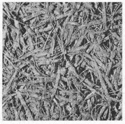
Struktur einer unbeschichteten Heraklith-Leichtbauplatte
