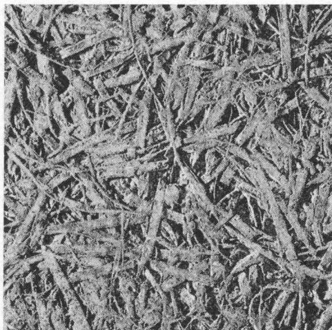
Struktur einer unbeschichteten Heraklith-Leichtbauplatte
