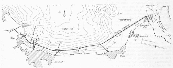
Bild 22. Trasseverlauf der Unterwasserpipeline des GVO im Bodensee mit Angabe der bestehenden Fremdleitungen 1 bis 11
