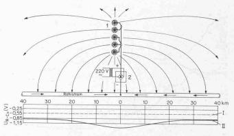
Bild 21. Schema der kathodischen Schutzanlage
