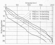
Bild 32. Diagramme der Arbeitsfortschritte. 1 Pistenvorbereitung, 2 Schweissen, 3 Absenken, 4 Wiederherstellen
