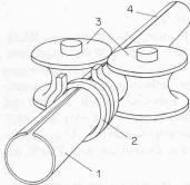
Bild 13. Hochfrequenz-Widerstands-Schweissung. Die Blechkanten des Schlitzrohres 1 werden mit dem Ringinduktor 2 auf Schweisstemperatur gebracht. Die Druckrollen 3 pressen die beiden Blechkanten aneinander, wodurch eine dem Blech gleichwertige Naht entsteht. 4 fertiggeschweisstes Rohr (Werkbild Thyssen)
