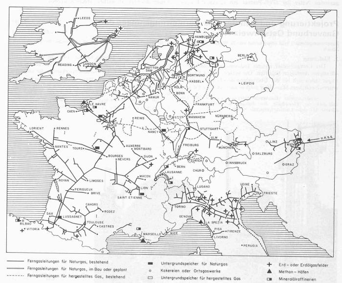
Übersicht über den europäischen Gastransport. Für die Länder des Ostblocks fehlen uns neuere zuverlässige Angaben, weshalb auf die Eintragung der Leitungsnetze verzichtet wurde
