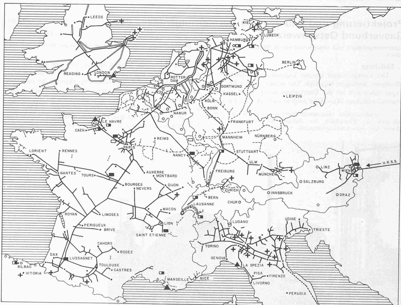
Übersicht über den europäischen Gastransport. Für die Länder des Ostblocks fehlen uns neuere zuverlässige Angaben, weshalb auf die Eintragung der Leitungsnetze verzichtet wurde
