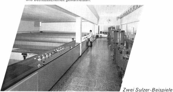
▲ Schnellfilteranlage «Champ-Bougin» der Stadt Neuenburg für das Aufbereiten von Seewasser zu Trinkwasser. Leistung 1800 m³/h
