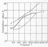
Bild 7. Luftschallisolation einer Backstein-Doppelwand im Vergleich zu einer einfachen Backsteinwand von 12 cm
