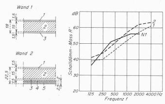
Bild 6. Verbesserung einer Kalksteinwand durch eine Vorsatzschale Kurve 1: Messkurve der Wand 1, Luftschallisolationsindex
