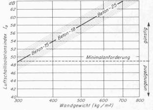
Bild 5. Luftschallisolation von einschaligen Betonwänden
