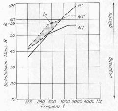
Bild 2. Bewertung einer Luftschall-Isolationsmessung gemäss ISO-Empfehlung R 717, am Beispiel einer 20-cm-Betonwand Ergebnis: Luftschallisolationsindex  $I_a = 58 \text{ dB}$  Kurve N 1: Normkurve für die Luftschallisolation (ISO R 717)
