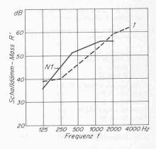
Bild 4. Verlauf des Schalldämm-Masses bei 18-cm-Isoliersteinwänden. Prüfschall Rosa-Rauschen; Empfangsfilter 1/1 Oktavband Kurve 1: Messkurve, Luftschallisolationsindex  $I_a=50~\mathrm{dB}$  Kurve N 1: Normkurve ISO R 717 ( $I_a=52~\mathrm{dB}$ )
