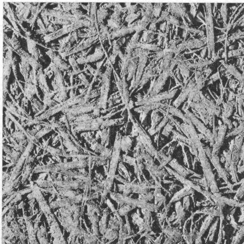
Struktur einer unbeschichteten Heraklith-Leichtbauplatte
