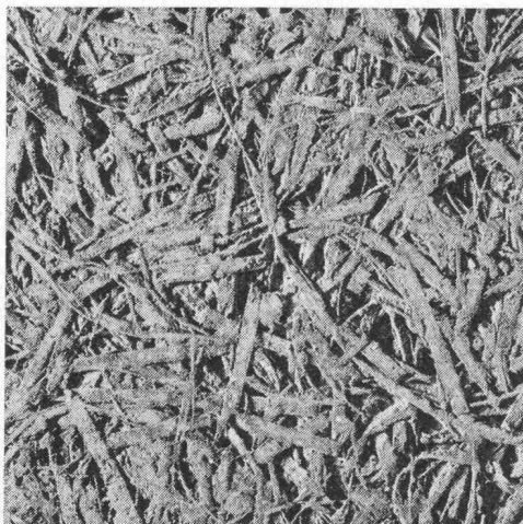
Struktur einer unbeschichteten Heraklith-Leichtbauplatte
