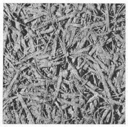
Struktur einer unbeschichteten Heraklith-Leichtbauplatte
