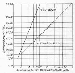
Bild 1. Einfluss des Umschmelzens auf das Warmrundlaufverhalten von Kalanderwalzen
