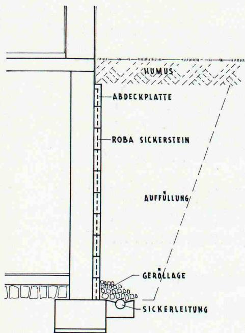
Typen: Sickerstein und Abdeckplatte
