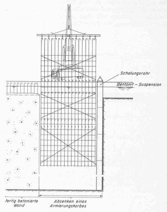
Bild 10. Zweite Phase, Einbringen der Armierung
