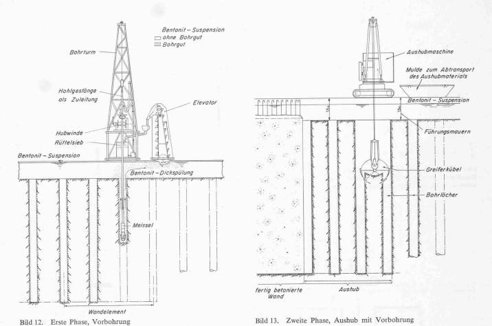
Bilder 12 und 13: Bauphasen beim Bauvorgang mit Vorbohren; Längsschnitte durch die Betonwand
