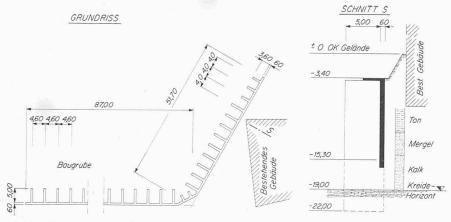
Bild 7. Geschäftshaus in St-Cloud, Paris Wandlänge ohne Rippenzuschlag 140 m. Wandtiefe ab OK Terrain 22 m. d = 60 cm einschliesslich Rippen. Rippenabstand 4 bis  $4,6\,\mathrm{m}$
