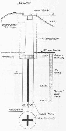
Bild 8. SBB-Brücke in Mellingen Bentag-Kreuz als Fundation für Brückenpfeiler. Tiefe 33 m ab OK Planum, wovon 15 m Schacht. Dicke 60 cm. Abmessung  $4.6 \times 4.6$  m
