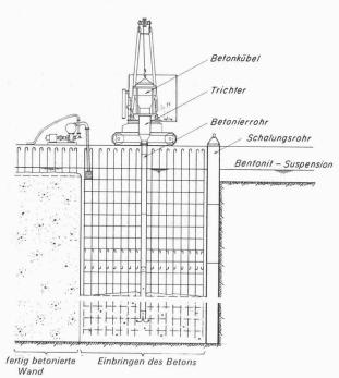
Bild 11. Dritte Phase, Betonieren
