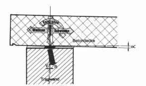
Die Betondecke kann sich auf der Tragwand verschieben und verdrehen, die Last bleibt zentrisch
