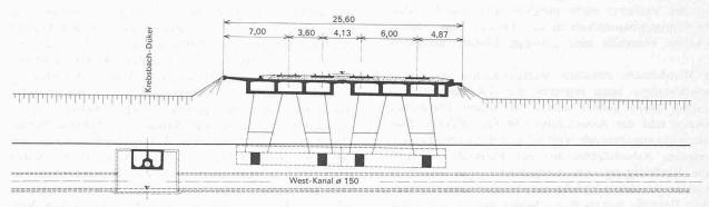
Überführung der SBB über die Autobahn in Wil. Querschnitt 1:450 des fertigen Bauwerks
