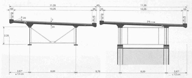
Lützelmurgviadukt bei Aawangen. Querschnitt 1:150 durch die Zwillingsträger in Stahlverbundkonstruktion; links in Feldmitte, rechts beim Pfeiler
