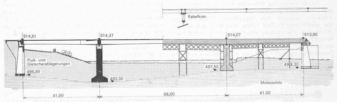
Thurbrücke Felsegg bei Henau. Längsschnitt 1:1000, links fertig, rechts im Bauzustand mit Lehrgerüst
