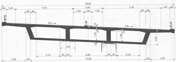
Tössbrücke in Wülflingen. Querschnitt 1:150 durch den dreizelligen Spannbetonhohlkasten
