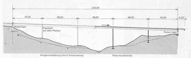
Lützelmurgviadukt bei Aawangen. Links Ansicht, rechts Längsschnitt mit Trägeransicht innen. Massstab 1:1500
