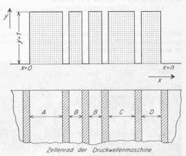
Bild 2. Angenommene Druck- und Geschwindigkeitsverteilung beim Ein- und Austritt des Zellenrades der Druckwellenmaschine
