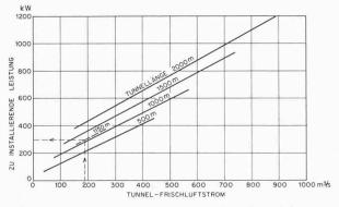
Bild 5. Zu installierende Leistung für die Halbquerlüftung
