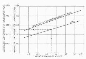
Bild 1. Luftstrom in Abhängigkeit von der Tunnelluft-Längsgeschwindigkeit
