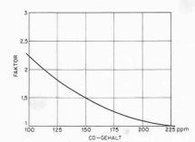
Bild 7. Multiplikationsfaktor für die Aenderung des Luftstromes in Abhängigkeit von der veränderlichen CO-Konzentration
