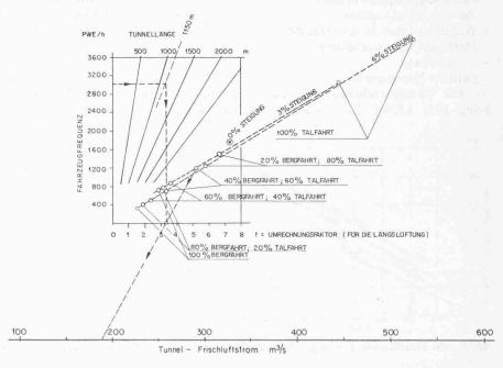
Bild 3. Nomogramm zur Bestimmung des Tunnel-Frischluftstromes bei einer CO-Konzentration von 225 ppm
