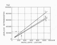
Bild 9. Jährliche Energiekosten für die Halbquerlüftung
