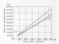
Bild 10. Jährliche Energiekosten für die Querlüftung
