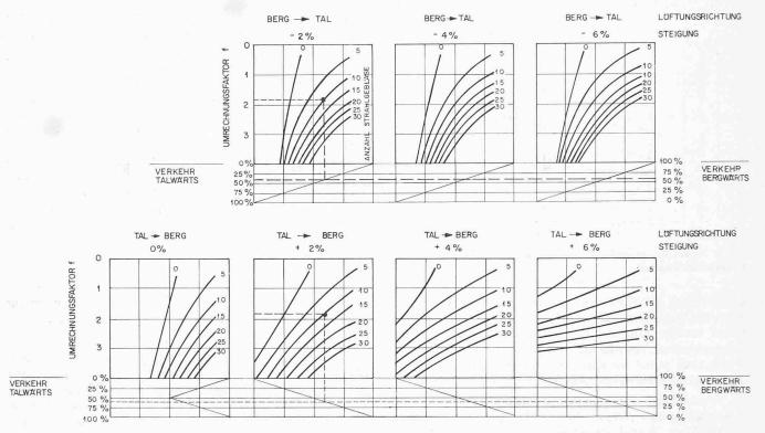
Bild 4. Bestimmung der Anzahl Strahlgebläse für die Längslüftung
