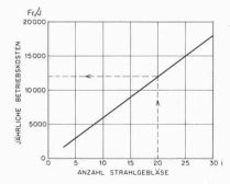
Bild 8. Jährliche Energiekosten für die Längslüftung
