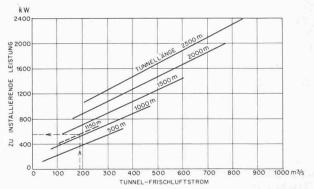
Bild 7. Zu installierende Leistung für die Querlüftung
